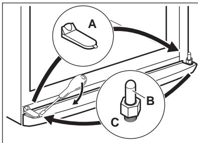
С помощью инструмента (A) отвинтите палец нижней петли (B) и установите его на противоположную сторону. Поставьте крышку (A) на противоположную сторону.
