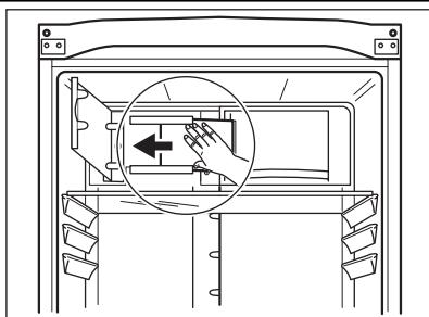
Фильтр TasteGuard представляет собой фильтр с активированным углем, поглощающий неприятные запахи и обеспечивающий сохранение наилучшего вкуса и аромата всех пищевых продуктов без смешения запахов. Чтобы обеспечить сохранение характеристик и срока службы угольного фильтра, при поставке он находится в пластиковом пакете. Перед включением прибора фильтр следует установить за заслонкой.
