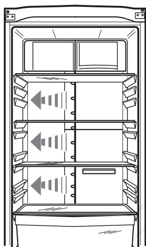
Технология Multiflow позволяет быстрее охлаждать продукты и поддерживать более равномерную температуру в отделении.
