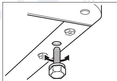
При установке прибора убедитесь, что он стоит ровно. Это достигается с помощью двух регулируемых ножек, расположенных спереди внизу.
